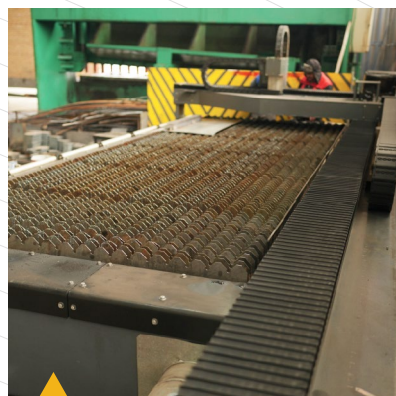
دستگاه برش CNC لیزر از ورق الی ۵۰ میلی متر با دقت ۰/۱ میلی متر
