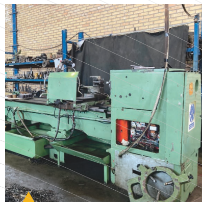
دستگاه تراش ۳/۵ متری با قابلیت تراش تا قطر ۱۲۰۰ میلی‌متر
